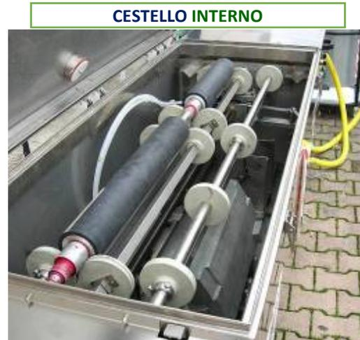
La nostra vasca di lavaggio modello "ORION" é stata progettata per soddisfare le esigenze delle aziende nel settore STAMPA ETICHETTE che necessitano di lavare cilindri, vaschette di inchiostrazione, coperture laterali e racle. La versione pneumatica idonea per il lavaggio con solventi industriali, la versione elettrica idonea per lavaggio acqua e detergente.
