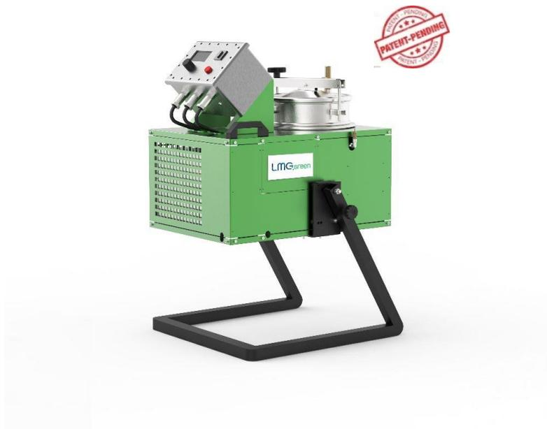
I distillatori per solventi/acqua modello “LM” sono stati progettati per soddisfare le esigenze di tutte le aziende che necessitano di distillare/recuperare solventi/acqua inquinati durante il processo lavorativo da inchiostri, pigmenti, oli o grassi e che per problemi logistici dispongono di spazi limitati.
