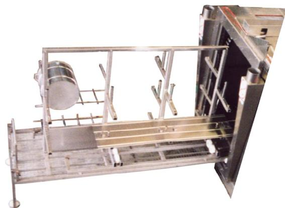
Il nostro tunnel di lavaggio modello “LIBRA” é stata progettata specificatamente per i componenti provenienti da macchine da stampa Roto e Flexo (vaschette inchiostro, coperture laterali, serbatoi di inchiostro, racle, strumenti e altri componenti).
